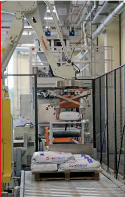
Il nuovo impianto di confezionamento installato in Poliblend riesce a gestire in un giorno i quantitativi che la precedente linea lavorava in una settimana
